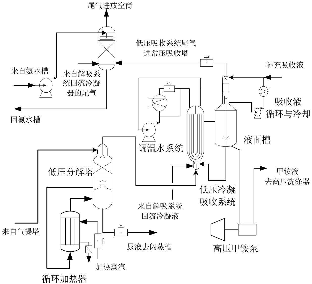
图 3-5 低压分解与循环回收系统
